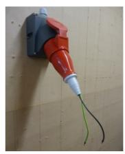
Подготовленные разъёмы соединяется с соответствующими разъёмами ЭУ. К полученным проводникам подключаются электроды мегомметра.
